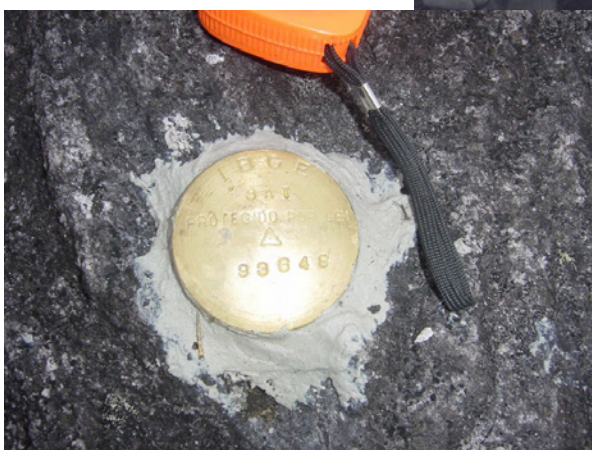
Coleta de dados realizada, em campo. GPS geodésico posicionado sobre estação geodésica passiva, uma chapa cravada em rocha no Pico da Neblina.
